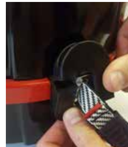
Étape 2 : Retirez les deux moitiés de l'ensemble de buse
